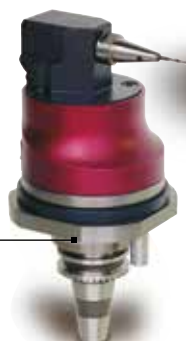
TFS 39999 Testa ad angolo speciale fresatura su plastica peso kg 4 Milling angle head for plastic weight kg 4
